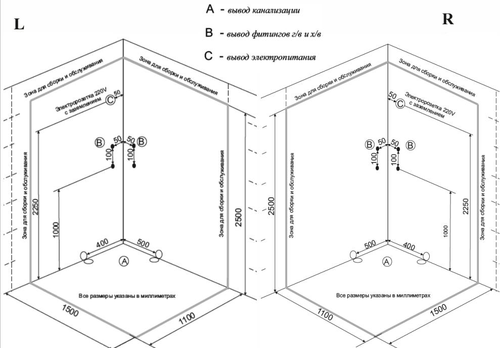
Ⓐ Ⓑ Сделать один вывод канализации и два вывода воды (горячая и холодная) в зависимости от расположения канализационного стояка и стояков горячей и холодной воды (справа или слева)
